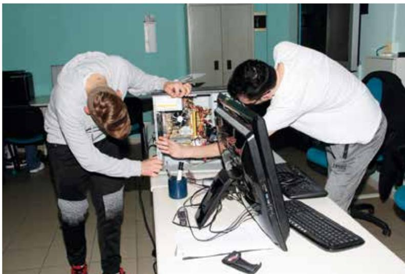
*Posizionamento dei componenti di un PC durante il riassettaggio.*
